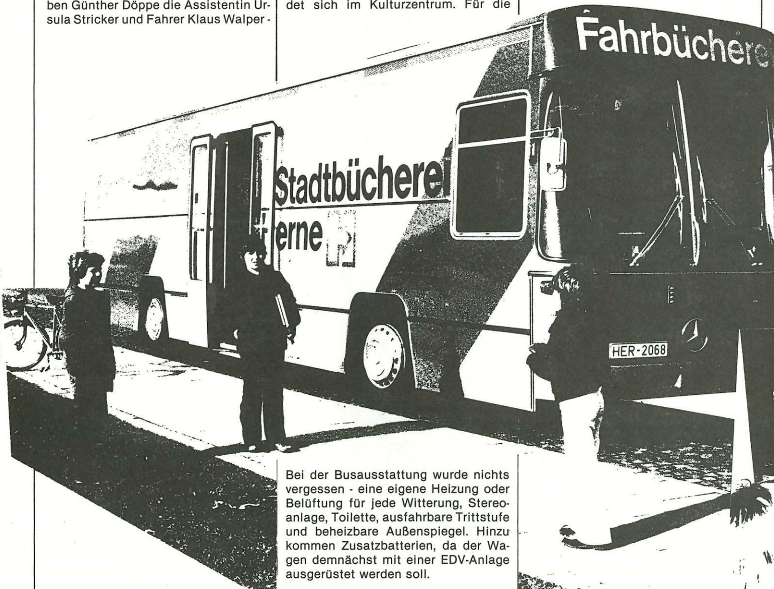
Bei der Busausstattung wurde nichts vergessen - eine eigene Heizung oder Belüftung für jede Witterung, Stereoanlage, Toilette, ausfahrbare Trittstufe und beheizbare Außenspiegel. Hinzu kommen Zusatzbatterien, da der Wagen demnächst mit einer EDV-Anlage ausgerüstet werden soll.
