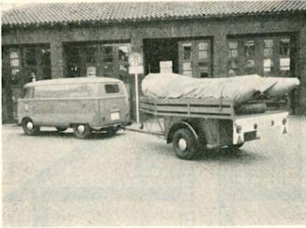
Pulverlöschfahrzeug mit Schlauchbootanhänger.
